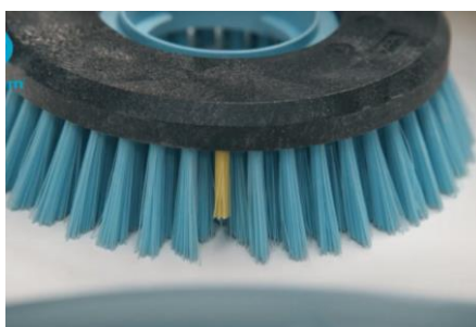
Børster skal erstattes når de er slidt ned til det gule kontrolpunkt.
